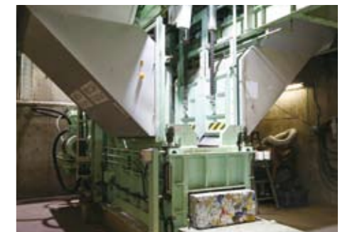
金属プレス機 選別回収された鉄分とアルミ分は、金属プレス機により圧縮成型されます。
