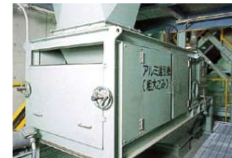
アルミ選別機 分離された資源ごみよりアルミを選別します。
