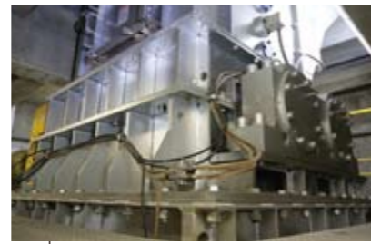
破袋機 収集袋を破き、給じん機へ送ります。
