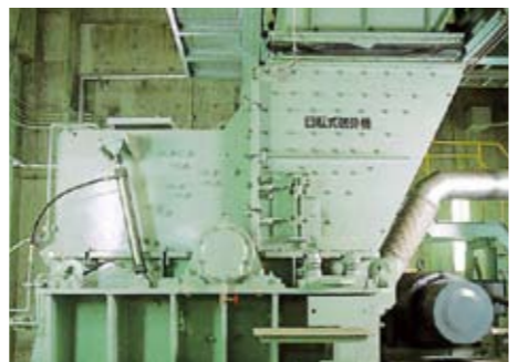
回転式破砕機 粗大ごみは回転式破砕機で破砕されます。
