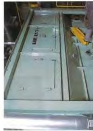
磁選機 ごみの中の鉄分を磁選機で回収します。
